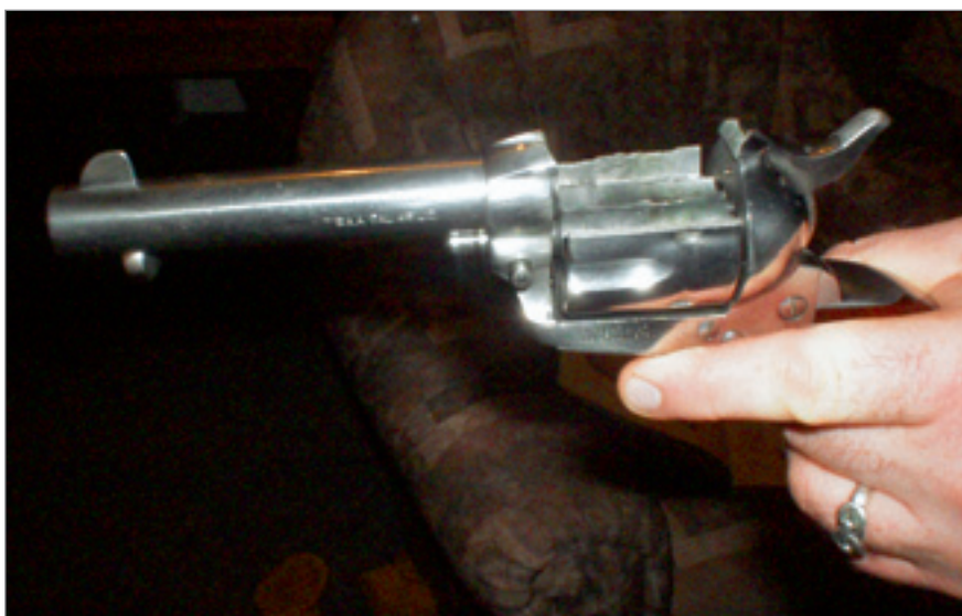
Následky odpálení náboje s dvojitou náplní v jednočinném revolveru
