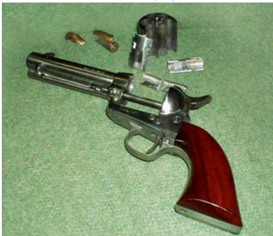
Následky odpálení náboje s dvojitou náplní v jednočinném revolveru
