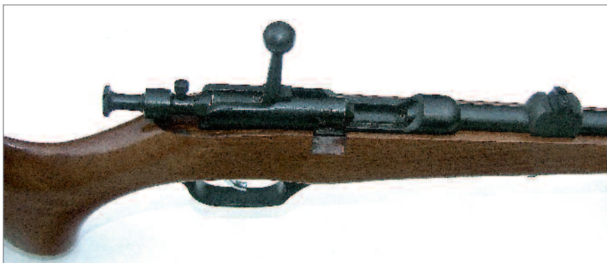
☛ Testovaný model Spielberg 100 F s otevřeným závěrem. Dobře viditelné je zkosení čela závěru a hlaveň kolem komory.
