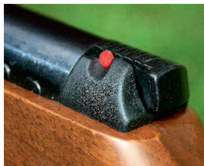
◀ Zbraň je vybavena pojistkou, která je u vzduchovek Webley obvyklá. Zatlačením pojistky vpřed zbraň odjistíte a ve výřezu se objeví červený bod.
