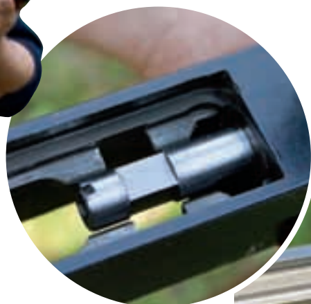
☛ Přestavba začíná. Původní závěr je pryč a je vložena nová komora, resp. kratší část hlavně, jejíž část je opracována do čtvercového průřezu; na ni se nasadí spona.
