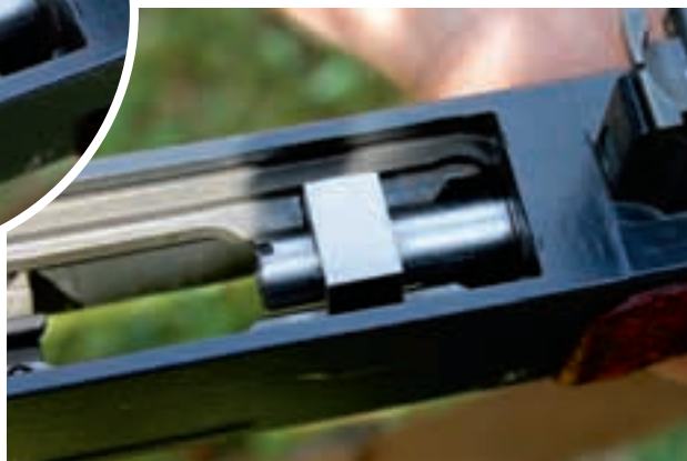
☛ Přestavba začíná. Původní závěr je pryč a je vložena nová komora, resp. kratší část hlavně, jejíž část je opracována do čtvercového průřezu; na ni se nasadí spona.
