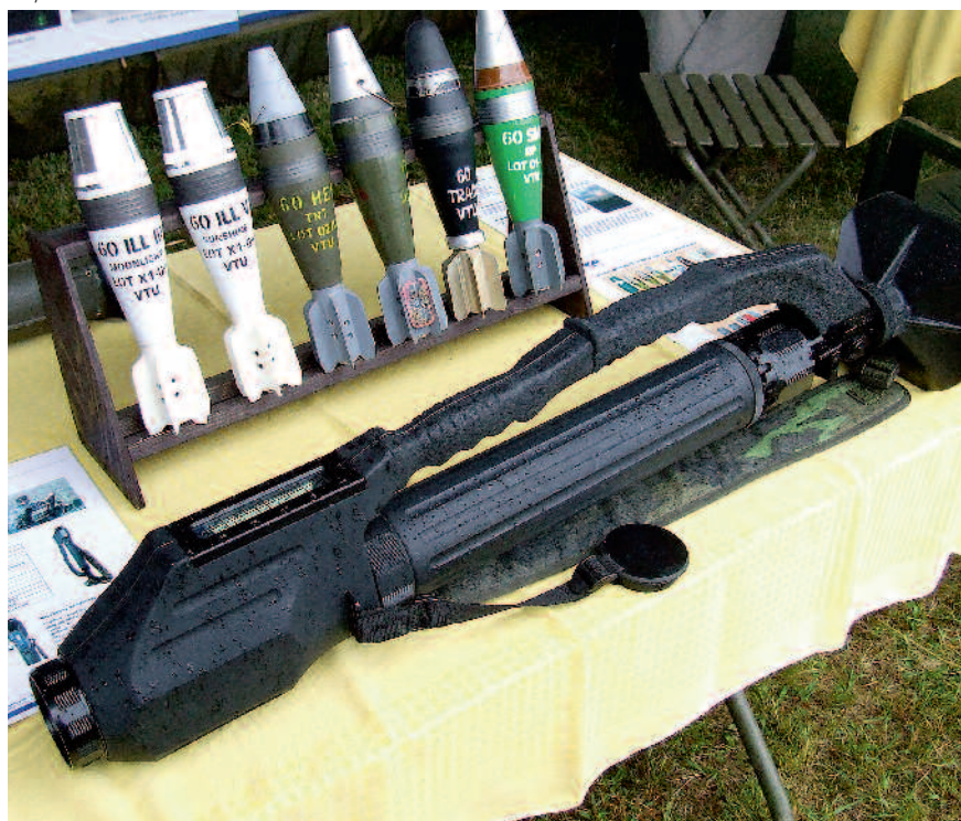
Část expozice stánku VOP-026 Šternberk, s. p., s minometem ANTOS Commando a šesti typy minometných nábojů na Bahnech 2011; volič je v poloze T. V horním kořenu nosné rukojeti je kapalino-vý zaměřovač minometu.
