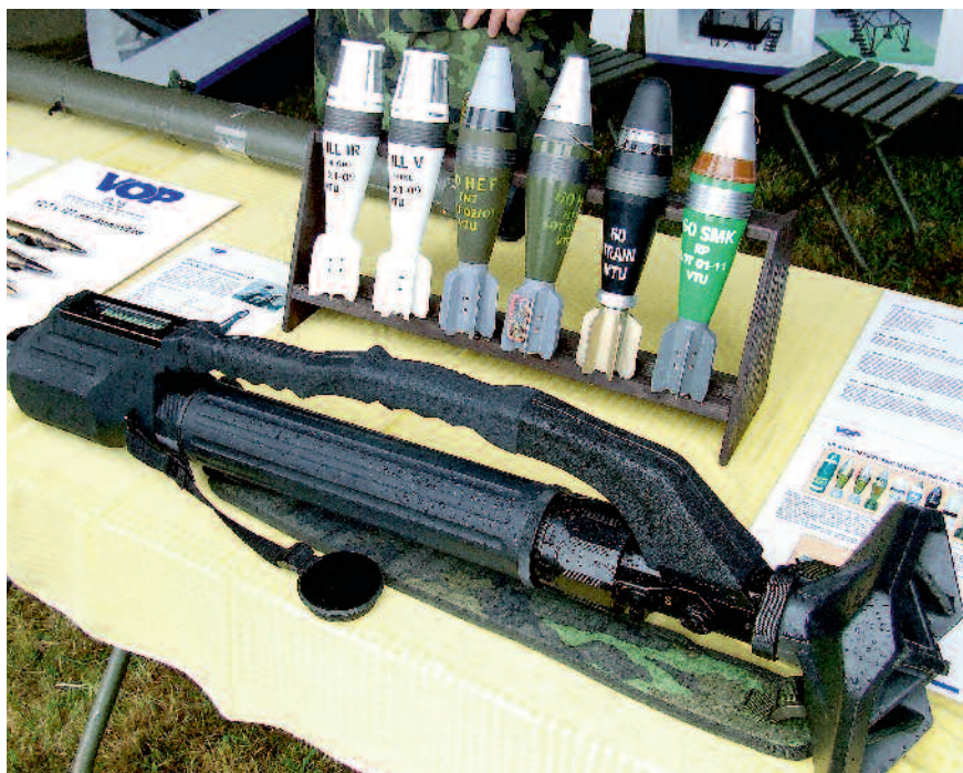
Část expozice stánku VOP-026 Šternberk, s. p., s minometem ANTOS Commando a šesti typy minometných nábojů na Bahnech 2011; volič je v poloze T. V horním kořenu nosné rukojeti je kapalino-vý zaměřovač minometu.
