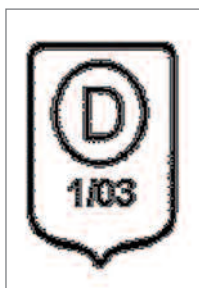
Kontrolní znehodnocovací značka, která musí být vyražena na znehodnocené zbraně
