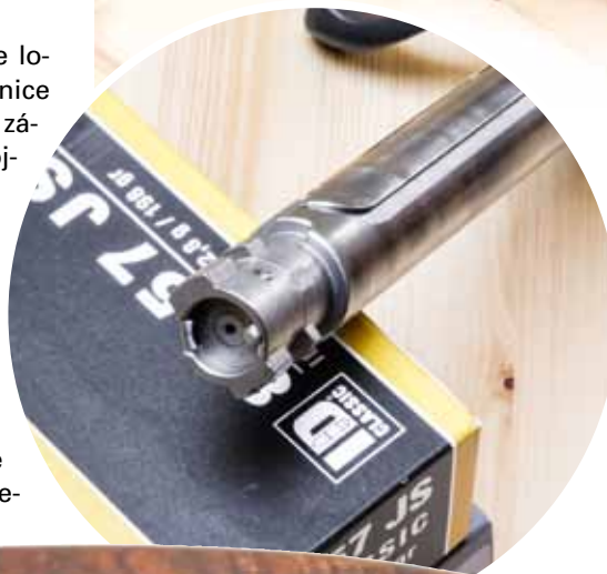
» Čelo závěru s vytahovačem a neseným vyhazovačem; čtyři uzamykací ozuby jsou ve dvou řadách
