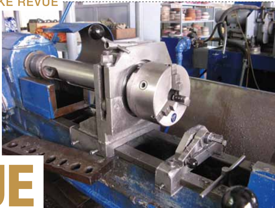
» Soustruh k opracování komor u hlavňových svazků
