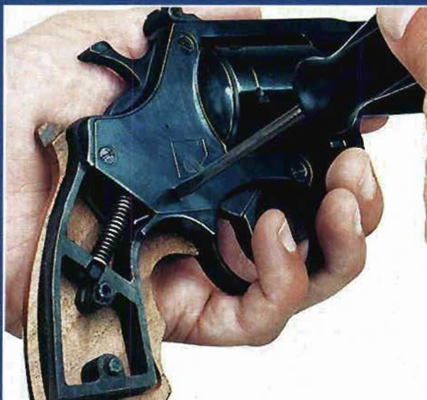
Regulace odporu spouště otvorem ve víku, přístupným po sejmutí pravé střenky
