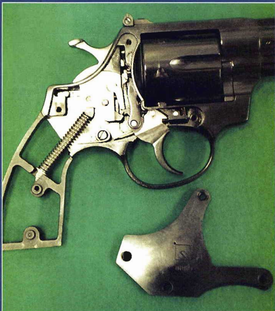
Pohled dovnitř po sejmutí stěnek a víka: osvědčený spoušťový a bicí mechanismus se šroubovou bicí pružinou, „plovoucím“ zápalníkem a tzv. uzavírací (přenosovou) pákou byl původně odvozen od německých plynových revolverů Röhm, avšak po několika provedených úpravách a vylepšeních už se fakticky jedná o vlastní konstrukci. Pod kohoutem je vidět stavěcí šroub odporu spouště. Výřez na pravé straně rámu v místě kohoutu musí být u tohoto ocelového modelu přemostěn.
