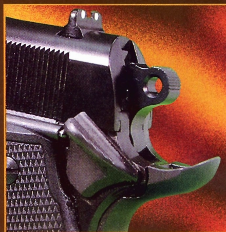
Na rozdíl od všech jednočinných klonů M1911 lze LDA zajistit jen s kohoutem téměř v přední krajní poloze
