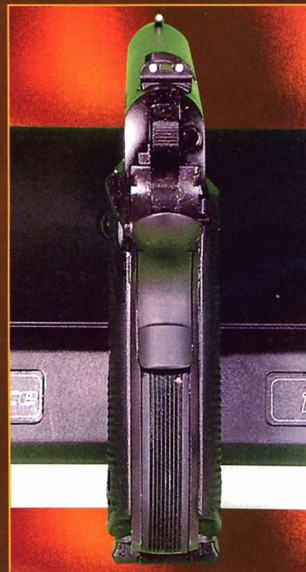
Pokud není zbraň řádně uchopena rukou, dlaňová pojistka blokuje pohyb spoušťové páky
