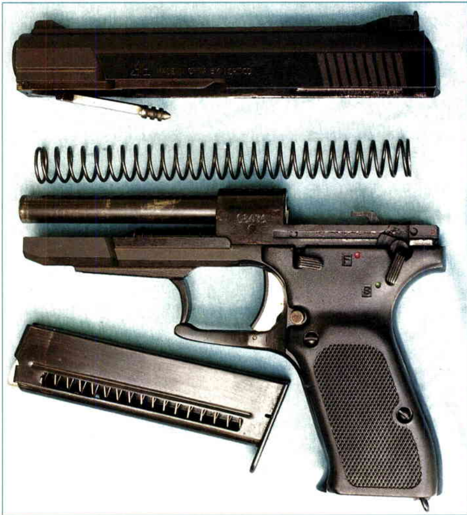
Zbraň rozložená k čištění - pod přední částí závěru je vidět kyvně uložený brzdící píst
