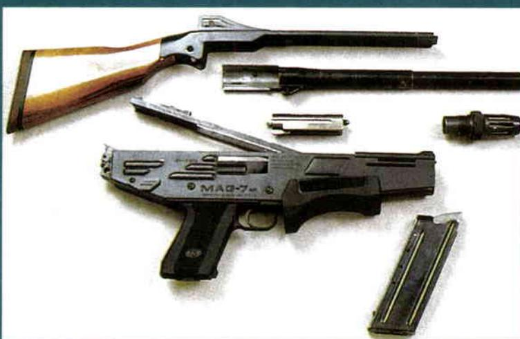
Bicí ústrojí je kladívkové, páčka pojistky na levé straně jistí přímo kladívko: bílé „S“ nahoru = zajištěno, červené „F“ dolu = odjištěno. Zajímavé je řešení ovládání pojistky levákem: na pravé straně pouzdra je menší páčka, jejíž pohyb se přenáší přičním čepem na levou stranu pouzdra a zde - pro-
