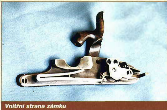
Spoušťový mechanismus s francouzským napínákem
