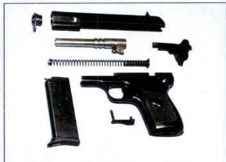
Hlavní části (shora): objímka hlavně, závěr, hlaveň, bicí mechanismus, vratná pružina, zásobník, rám, spojovací čep se záchytem závěru
