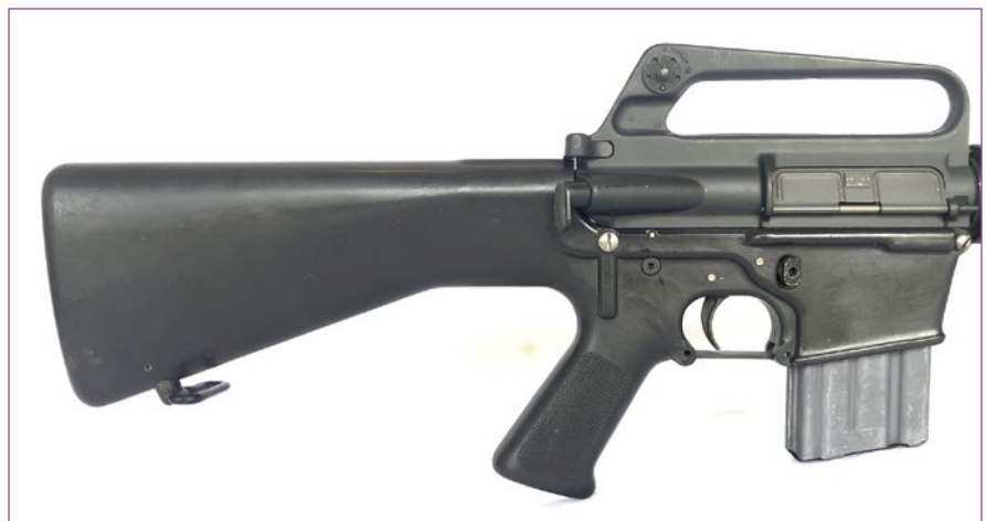
Prototyp plastového loweru od Coltu ze začátku 70. let
