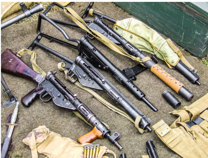
Zleva výsadkářský samopal Mk V s dřevěnou pažbou a oběma rukojetmi, Mk III od Lines Bros, dále Mk II se skeletovou opěrkou, utlumený Sten Mk II(S) a Sten Mk III v plátěném pouzdru (na Bahnech 2007)
