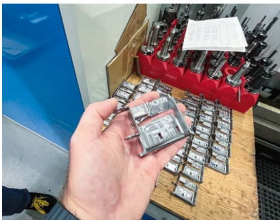
Obrobený nábojový stůl před kontrolou rozměrů
