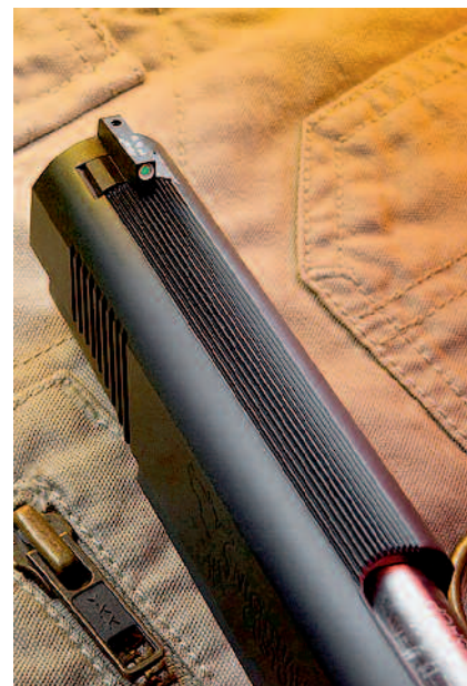
◀ Horní plocha závěry je rýhovaná proti rušivým odleskům
