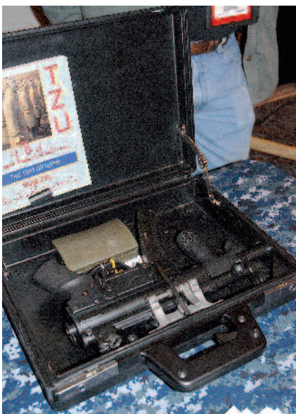
Mnohé návštěvníky zaujal „střílejší kufr“, tedy zavazadlo s instalovaným devítimilimetrovým samopalem HK MP5K. Může střílet přímo z neseného zavazadla, zaměřování obstarává vestavěný laser.
