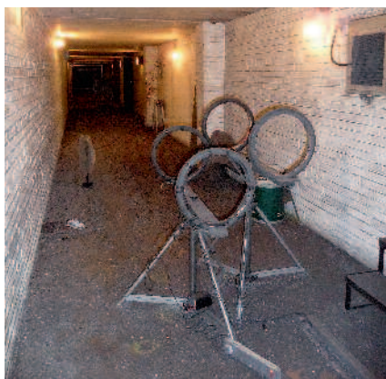
◀ Balistický tunel s kruhovými cídi průletu broků pro měření jejich rychlosti
