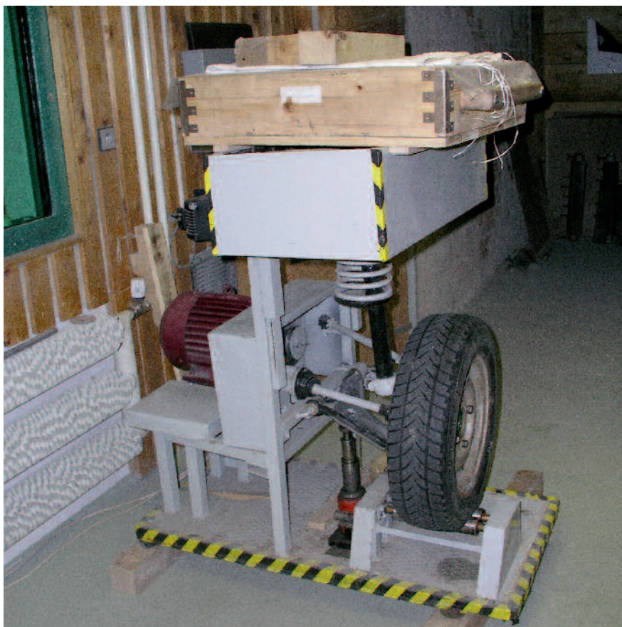
Zkoušky účinku na pneumatiky osobních vozidel: střelilo se na nahuštěnou pneumatiku uchytenou v zařízení pro simulaci odvalování pneumatiky
