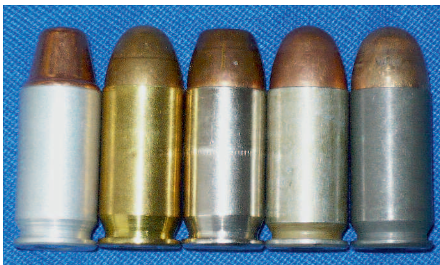
◀ Náboje 45 Auto s nábojnici z různých materiálů: zleva slitina hliníku, mosazná, poniklovaná mosaz, ocel pozinkovaná, ocel lakovaná
