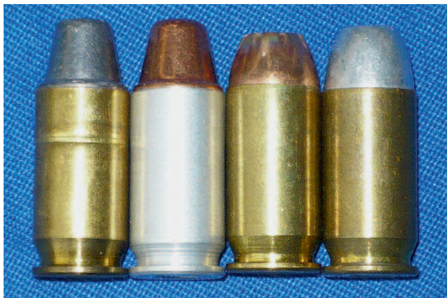
◀ Různé druhy střel: zleva olovená, olovená poměděná, expanzní, expanzní z lehké slitiny
