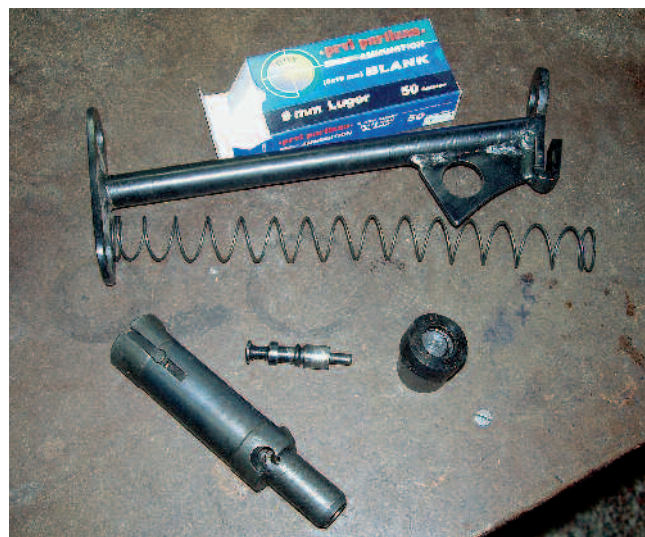
Pružina a závěr vyjmuté z pouzdra závěru. Při konečné montáži jsou tyto součástky v pouzdru závěru zavařeny tak, že je už nelze vyjmout. Tím ovšem není omezena odnímatelnost ramenní opěrky, kterou lze odmontovat jako u originálu.
