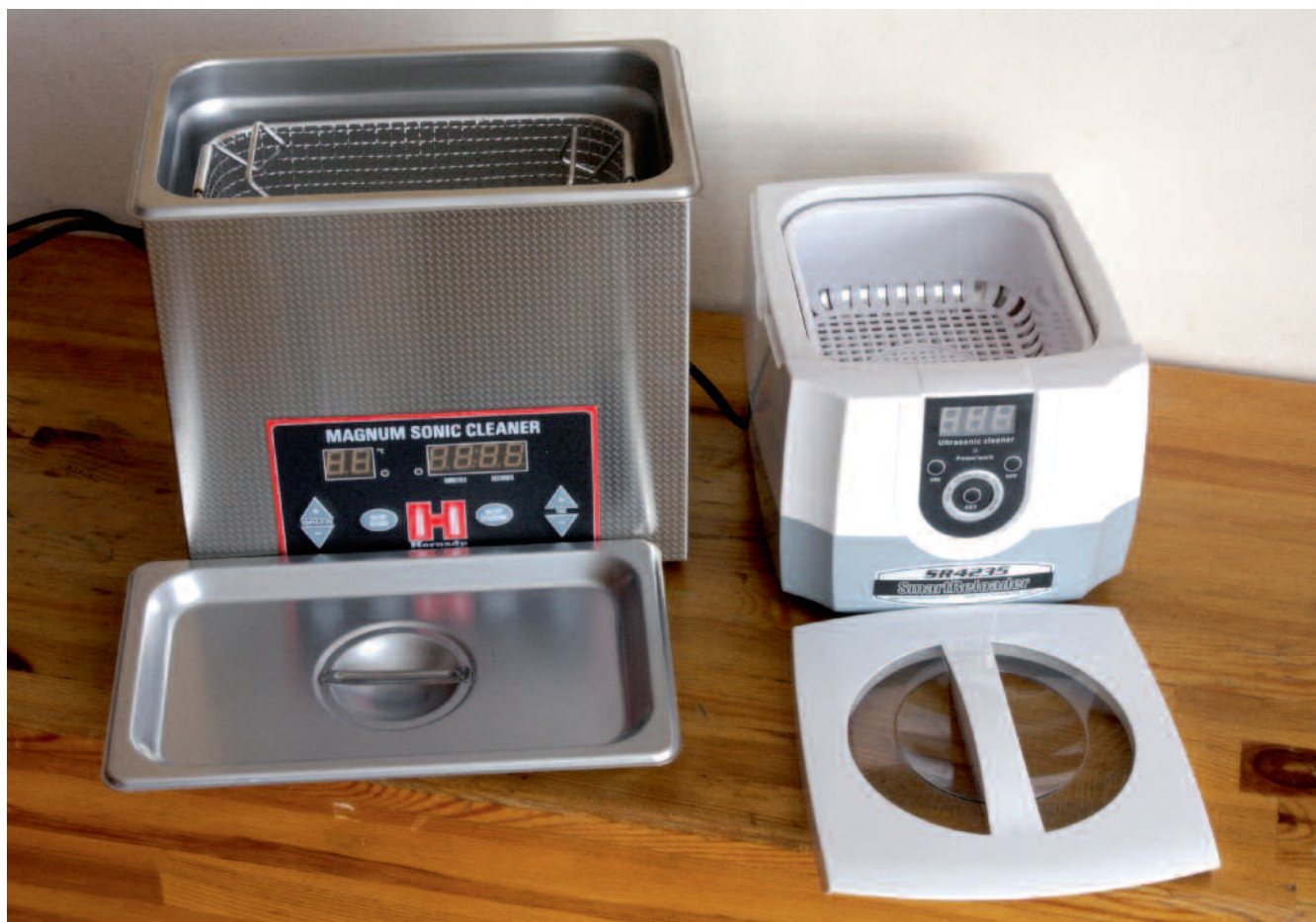
◀ Pračky s odkrytými nádobami. Vlevo Hornady Magnum Sonic Cleaner, vpravo SmartReloader SR4235. S výjimkou barvy plastu pračka SmartReloader jako by z oka vypadla malé pračce Hornady, nabízené od roku 2009 pod označením Sonic Cleaner. I Hornady si ji nechává vyrobit někde v Číně a zřejmě tam pracují na víc směn. Jediný, ale uživatelsky dost podstatný rozdíl je, že košík této pračky od Hornadyho má madla, za která se vyndává z nádoby přístroje.
