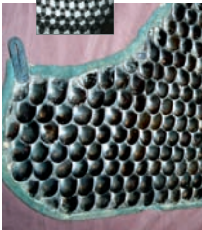
Dole je šupinová zbroj japonského samuraje, nahore rentgenový snímek materiálu DragonSkin
