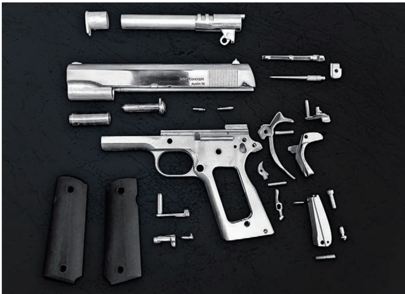
■ Tištěné součástky pistole 1911 DMLS
