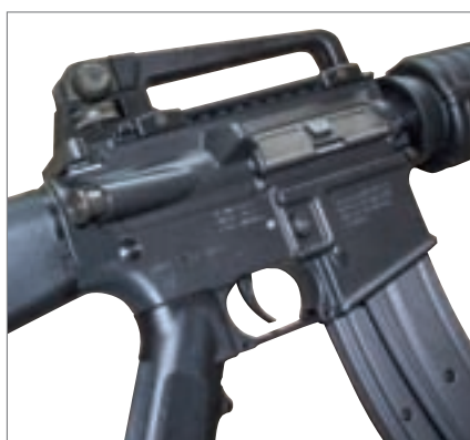
» Nosná rukojeť je upevněna na horní liště pro příslušenství
