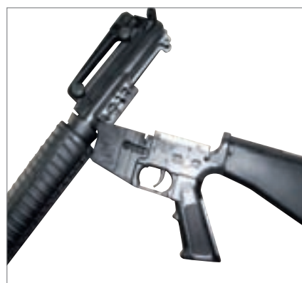
» Rozebrání pro čištění se omezuje na odklopení horního pouzdra
