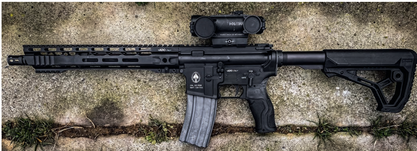
Samonabíjecí puška ADC M5 Basic Gen 2 jmenovité ráže 223 Remington s 12,5" hlavní, osazená kolimátorem Holosun 402 C
