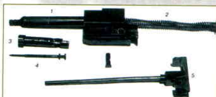
Součásti závěru TAR-21: 1 nosič závorníku, 2 vratná pružina s vedením, 3 rotační závorník, 4 úderník, 5 vedení závěru (podle MMS Komandos, č. 4/2000)
