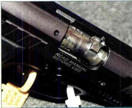
Asi po 6 mm společného zákluzu je závěr rotací hlavně odemčen a od tohoto bodu pokračuje pouzdro závěru v samostatném zpětném pohybu
