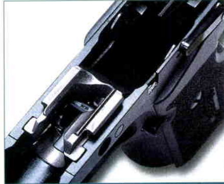
Ocelová vložka v rámu z hliníkové slitiny slouží jednak k vedení pouzdra závěru, jednak k vyvolání rotace hlavně. Hlavní výstupky se při zákluzu pohybuje po šikmé kulise.
