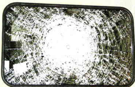
Výsledek zkoušky průstřelu skla
