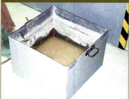
Zařízení pro zkoušení funkce zbraní v blátě vypadá jednoduše, ale umožňuje provedení zkoušky za přesně definovaných podmínek
