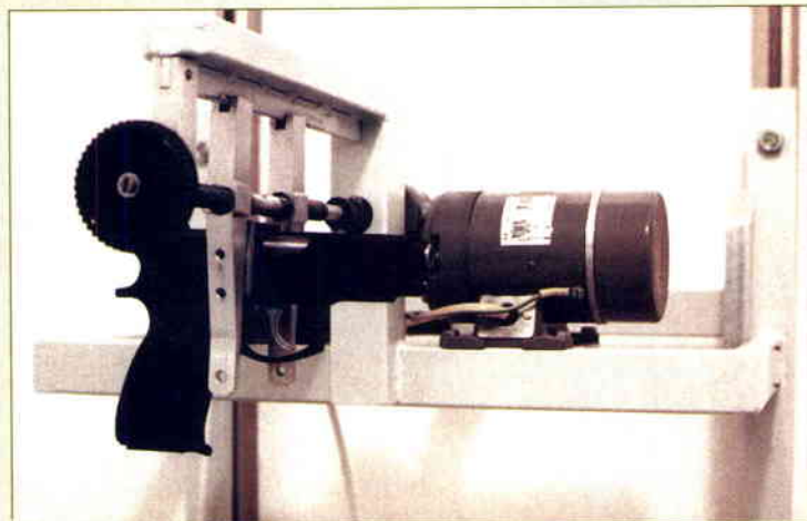
Aby byly podmínky pádových zkoušek přesně definované, zhotovili si k tomu ve Slavičíně speciální vypouštěcí zařízení s možností nastavení výšky
