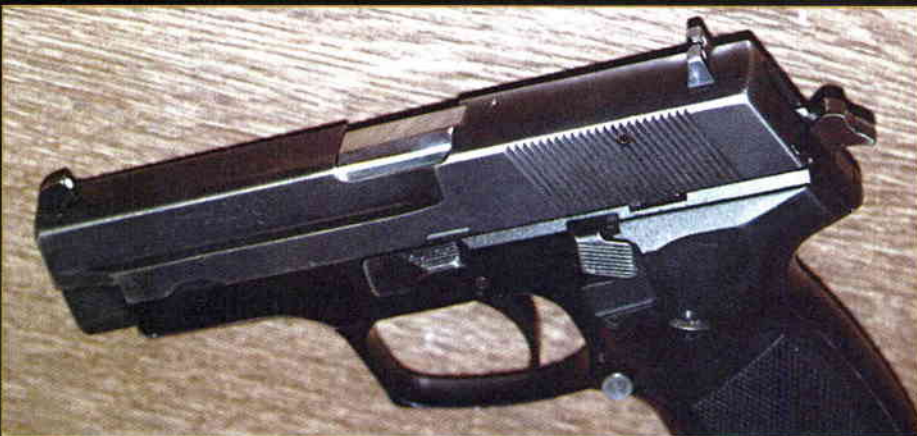
Výstražník na horní ploše závěru za výhozním okénkem je sotva viditelný a hmatem těžko zjistitelný
