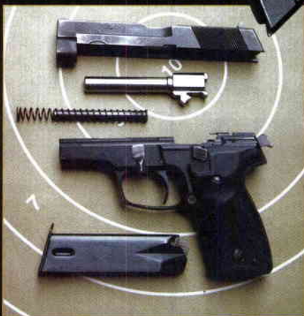
Páčka záchytu závěru s kombinovanou funkcí vypouštění kohoutu stejně jako tlačítko záchytu zásobníku jsou oboustranné
