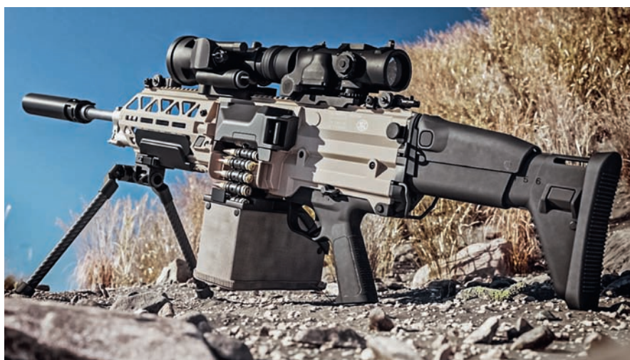
FN EVOLYS LMG ráže 7,62x51 mm NATO s tlumičem, osazený optikou s předsádkou, využívajícími prakticky celou délku montážní lišty
