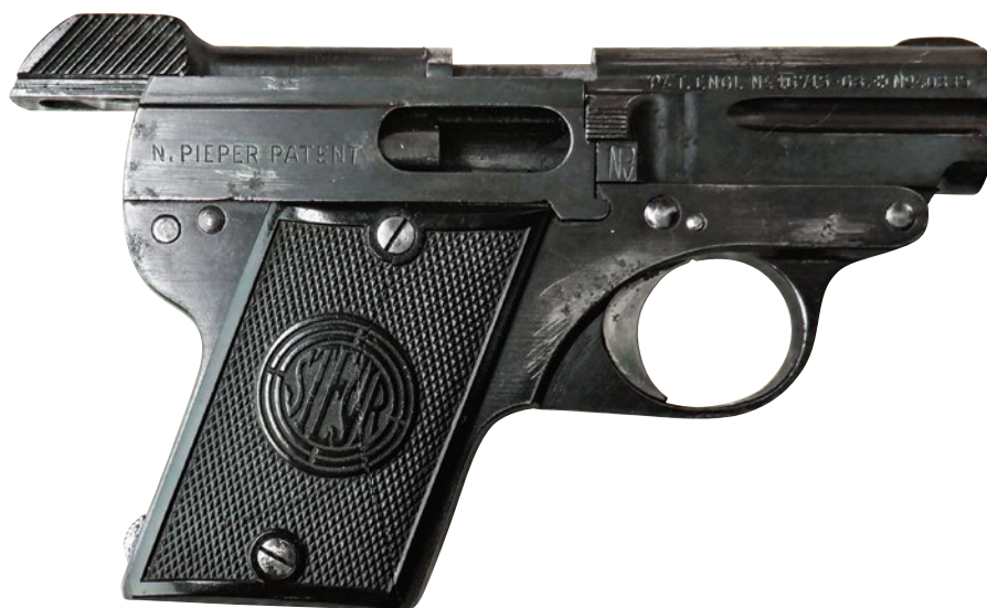
Pistole Steyr-Pieper ráže 6,35 mm Browning je elegantní zbraň, na které se nešetřilo výrobně náročnými díly. Po obou stranách hlavně jsou vypsány aplikované patenty.
