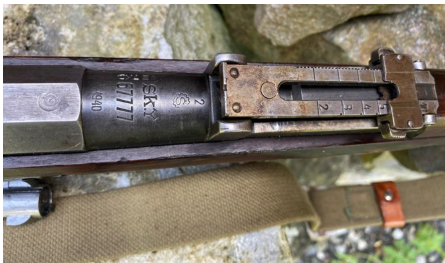
Pouzdro závěru s odřezovaným carským orlem na horní ploše. Hlaveň je z produkce Sako s odpovídajícím logem, rokem výroby a značkou gardy.
