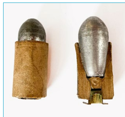
Kompletní pouzdro střely a jeho řez. Ačkoliv na řezu vypadá pouzdro jako dřevěné, je z papírové lepicí pásky.
