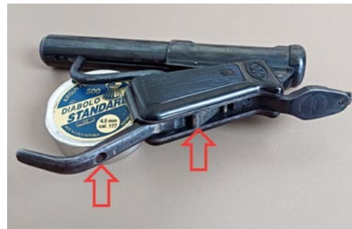
Píst v napnuté poloze. Vlevo kalibrační otvor pro diabolku, vpravo zajišťovací páka válce.
